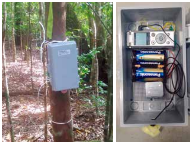
写真1 自動録音機の外見（左）と中身（右）。中身は防水のため、実際には機器をシリカゲル入りのジッパー付ポリ袋に保存した。
